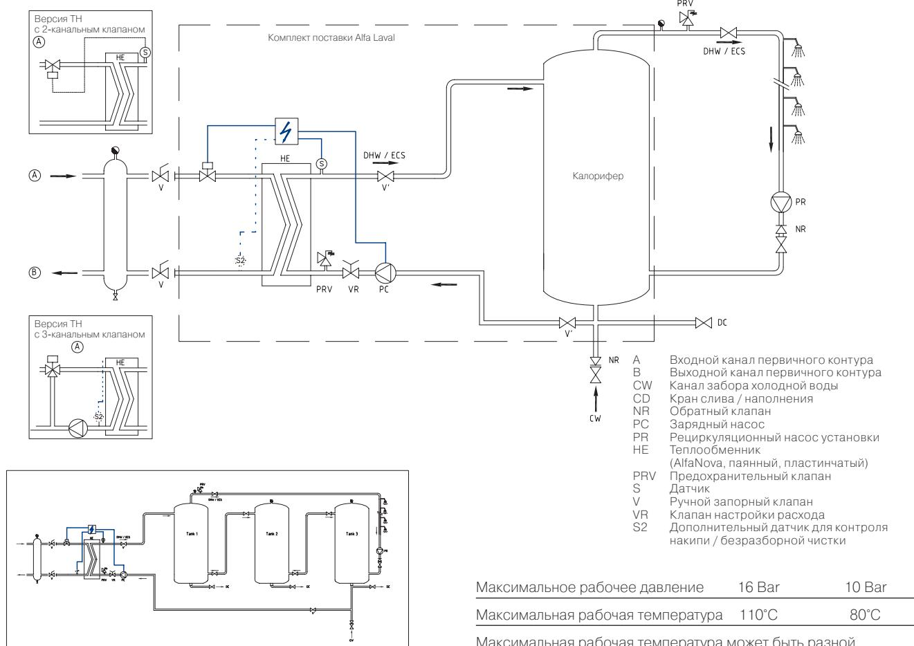
Принцип последовательного соединения нескольких накопительных баков
