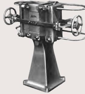
В 1931 году компания Альфа Лаваль представила первые пластинчатые теплообменники для молочной промышленности. Пластины были 5-10 мм толщиной и имели фрезерованную поверхность, тогда как сегодня толщина пластин составляет всего 0,4 мм. При разработке наших теплообменников мы всегда исходили из соображений экономической эффективности.
