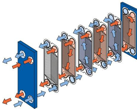
Схема течения потоков в теплообменнике с пластинаами типа М3Х.
