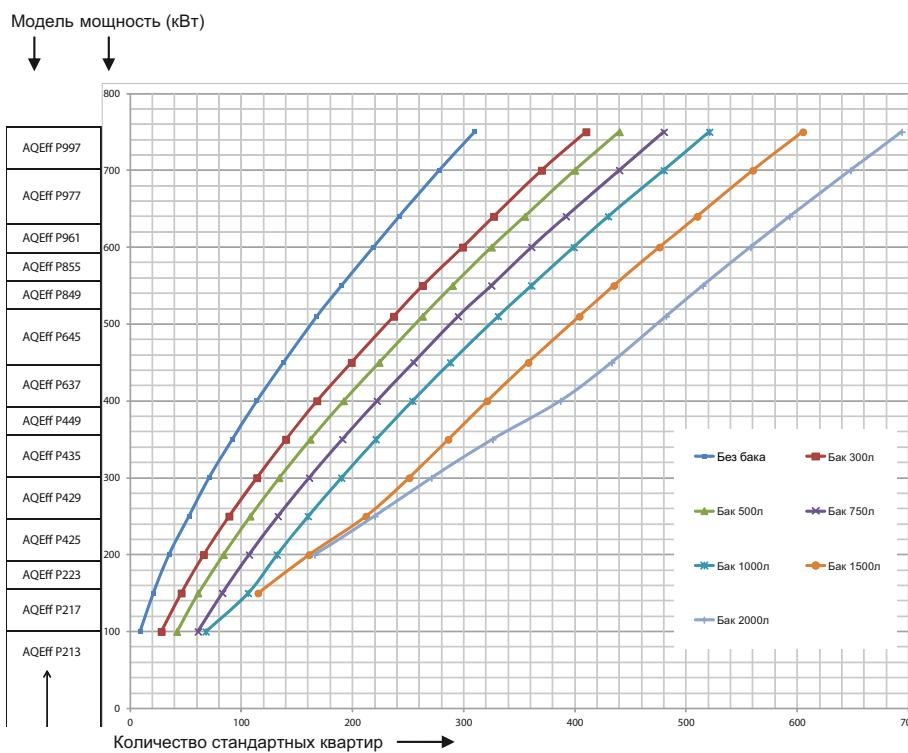
**Номограмма для подбора модели с паяным теплообменником или с теплообменником AlfaNova для систем с непосредственной подачей и баком-накопителем**
