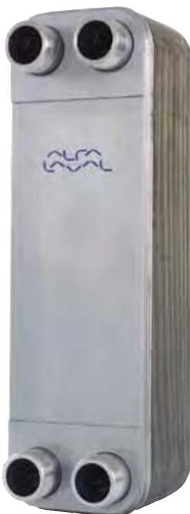
Теплообменник серии AlfaNova состоит из гофрированных пластин, внешних панелей и соединительных патрубков. Все компоненты изготавливаются из нержавеющей стали марки 316 и соединяются между собой методом активной диффузионной сварки по новой технологии AlfaFusion™, запатентованной компанией Альфа Лаваль.
