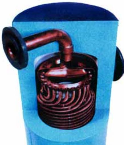
Размещение трубного пучка внутри кожуха
