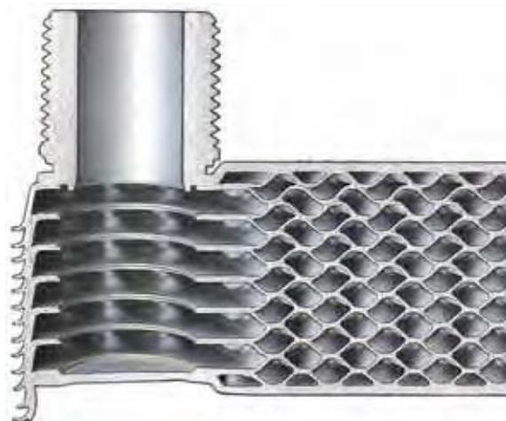
Применяемый метод сплавления по своей природе ближе к сварке, чем к пайке. Он основан на новой, поистине революционной технологии Альфа Лаваль под названием AlfaFusion™, позволяющей соединять между собой компоненты из нержавеющей стали без использования вспомогательного материала. Два компонента из нержавеющей стали плавятся в точках контакта между гофрированными пластинами, в результате чего образуется зона сплавления.
