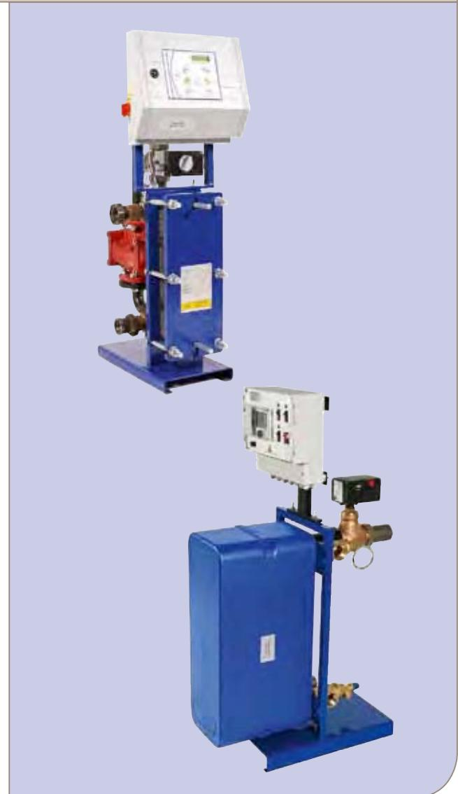
Датчик температуры (S), расположенный на выходе вторичного контура, обеспечивает контроль температуры и положение регулирующего клапана (VA), позволяющее поддерживать температуру горячей воды на необходимом уровне. Трубная обвязка регулирующего клапана позволяет обеспечить точное дозирование количества тепловой энергии, поступающей в первичный контур ПТО.
