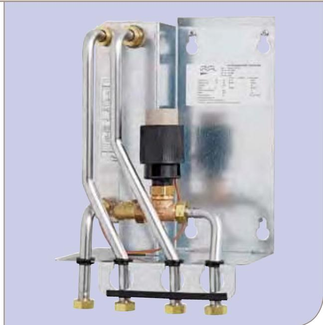
В модуле AquaMicro обеспечивается автоматическая регулировка температуры ГВС регулятором прямого действия. Он отслеживает температуру выходящей горячей воды в теплообменнике и автоматически регулирует расход нагревающей среды. Эта запатентованная собственная разработка Альфа Лаваль обеспечивает постоянство температуры горячей воды независимо от ее расхода и напора в линии ХВС.
