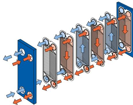
Схема течения потоков в теплообменнике с пластинаами типа М3.
