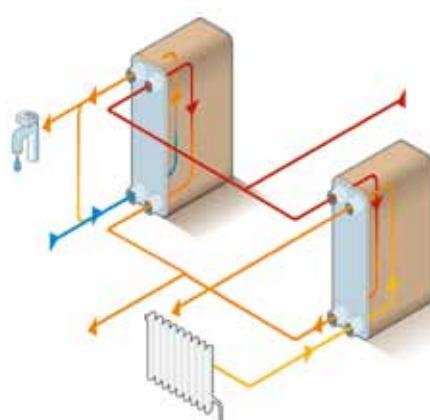
Независимое параллельное подключение
