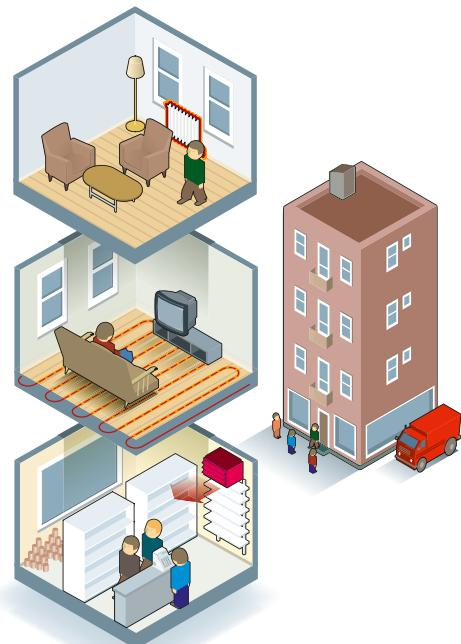
Цель отопления помещений обычно состоит в обеспечении комфортной температуры. тепло может поступать от радиаторов отопления, «теплого» пола или от воздухонагревателей.
