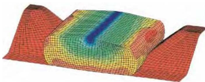
Наше отделение НИОКР добилось оптимальной конструкции системы уплотнений путем использования самых передовых технологий, в том числе моделирования методом конечных элементов. Трехмерное моделирование по этому методу позволяет рассчитать оптимальную форму и размеры прокладки и паза в пластине для достижения максимальной надежности уплотнения при минимальной толщине материала пластины.
