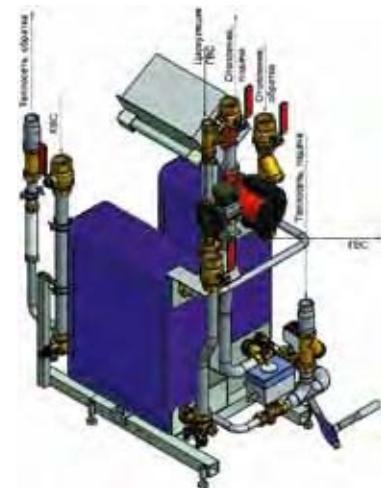
**Встроенная секция горизонтального расположения теплосчетчика с резьбовым соединением**
