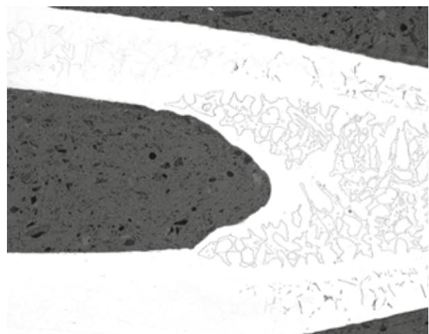
Характеристики зоны сплавления при использовании технологии AlfaFusion™ таковы, что получается однородный по составу материала пластинчатый теплообменник с высоким уровнем коррозионной стойкости и более высокой усталостной прочностью к механическим и термическим воздействиям, чем при применении других технологий.
