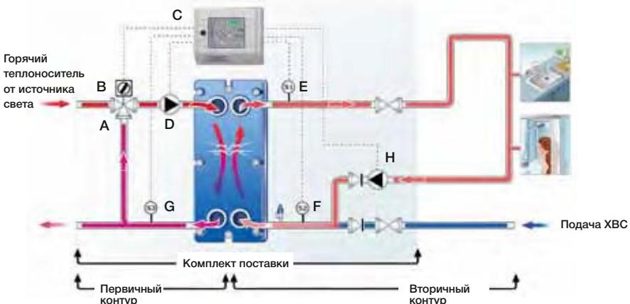
насос первичного контура (D) поддерживает постоянный уровень расхода, а температура воды на входе в теплообменник постоянно корректируется в соответствии с данными датчика S1 (E). Это предотвращает возможность перегрева в теплообменнике и снижает интенсивность образования накипи во вторичном контуре.
