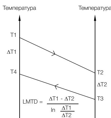
отданное одной стороной пластинчатого теплообменника (тепловая нагрузка), равно количеству тепла, полученному другой его стороной. Тепловая нагрузка (P) выражается в кВт или ккал/ч.
