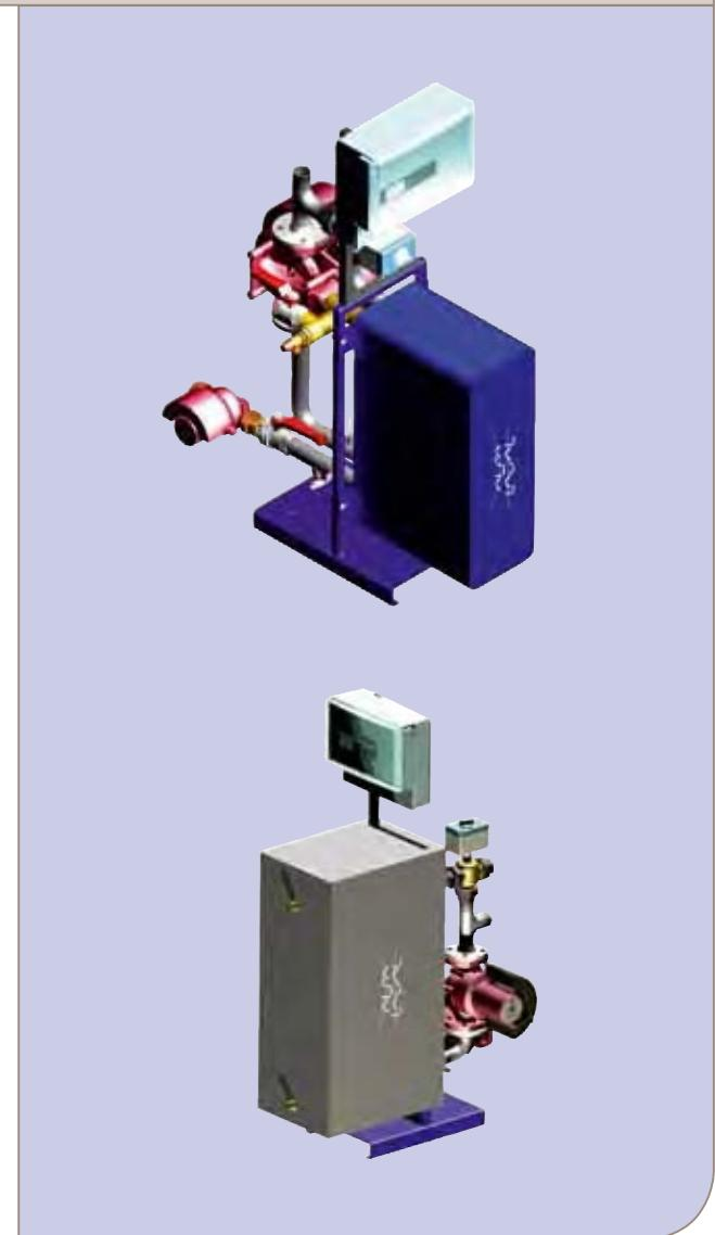
входе в теплообменник на стороне первичного контура подстраивается под уровень расхода на стороне потребителя. Такое решение уменьшает разницу температур в теплообменнике и снижает интенсивность образования отложений накипи во вторичном контуре.
