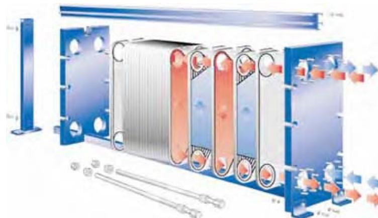
та пластин достигается благодаря использованию круглых несущих и направляющих балок.
