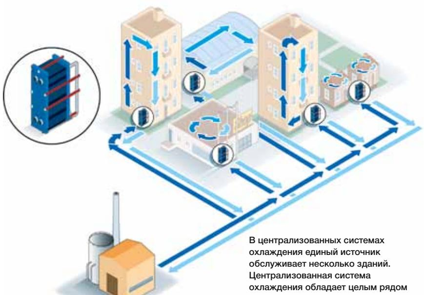
В централизованных системах охлаждения единый источник обслуживает несколько зданий. Централизованная система охлаждения обладает целым рядом преимуществ с экономической и экологической точки зрения, особенно если она соединена с системой централизованного теплоснабжения в единую оптимизированную систему.
