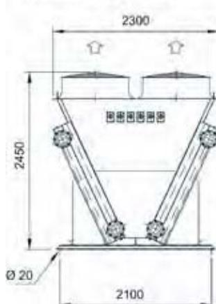
Вентилятор Ø 1240 мм
