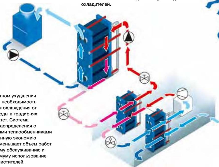
При повсеместном ухудшении качества воды необходимость защиты систем охлаждения от загрязнения воды в градирнях постоянно растет. Система раздельного распределения с промежуточными теплообменниками дает существенную экономию материалов, уменьшает объем работ по техническому обслуживанию и сводит к минимуму использование химических очистителей.
