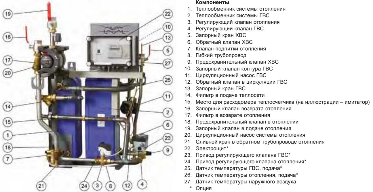
Для подключения к теплосети используются сварные соединения под размер DN25, для подключения линий контура ГВС – соединения с внутренней резьбой диаметром G1", для подключения контура отопления используется размер G1 1/2".
