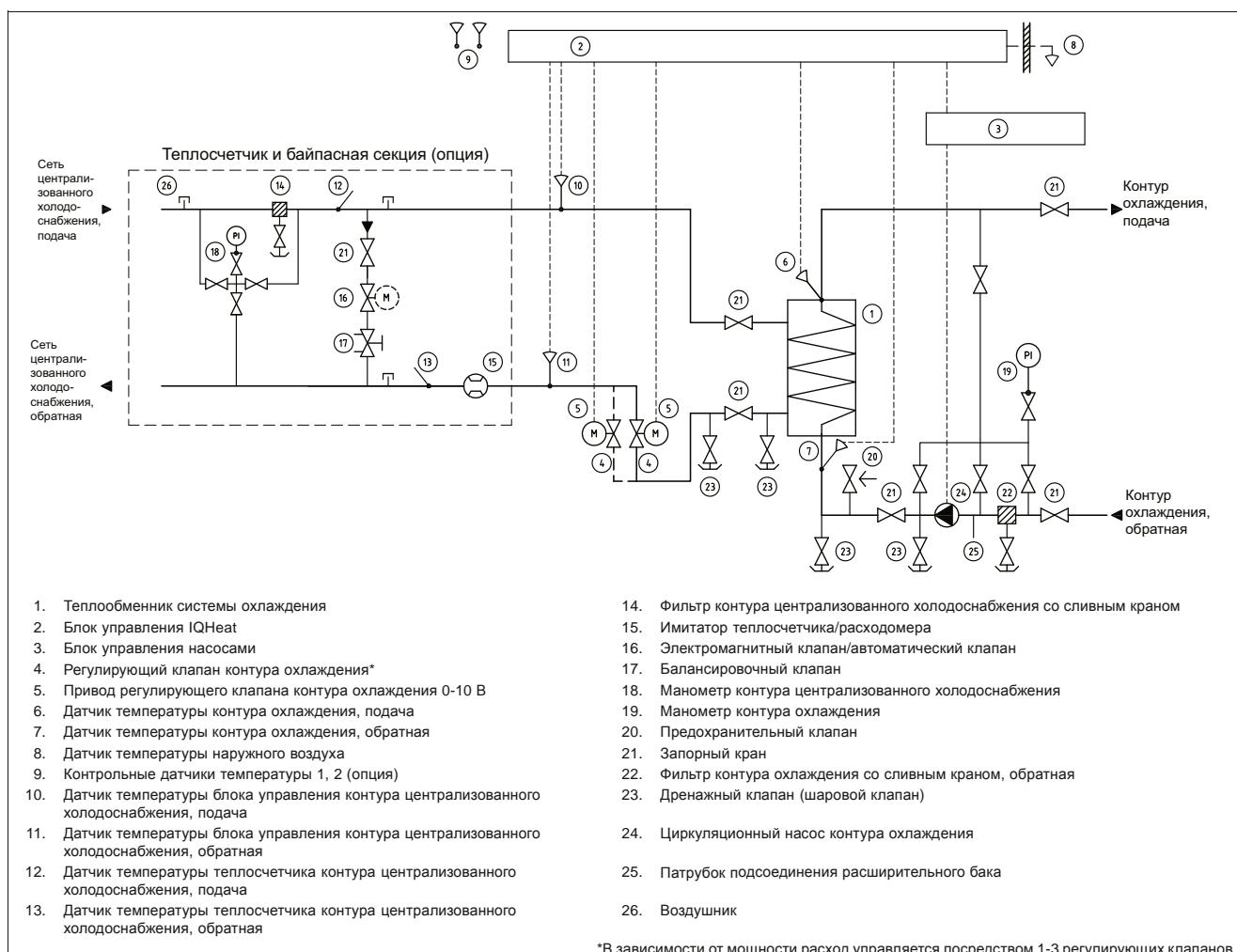
На схеме показан пример подключения стандартного модульного пункта холодоснабжения. Общие размеры модуля могут быть различными в зависимости от его холодопроизводительности и типа. Размеры приведены для варианта с теплообменником TL10.
