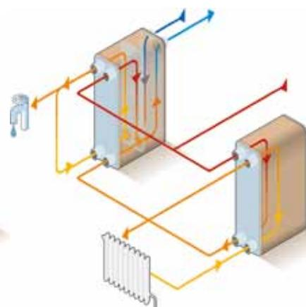
Независимое подключение с двухступенчатой системой ГВС
