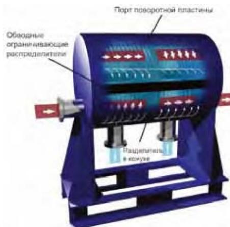
Схема течения теплоносителей в многоходовом теплообменнике AlfaDisc.
