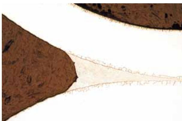
Хотя пайка медью и позволяет изготовить высококачественный пластинчатый теплообменник, процесс пайки необходимо тщательно контролировать, так как в противном случае медь может проникнуть в нержавеющую сталь.
