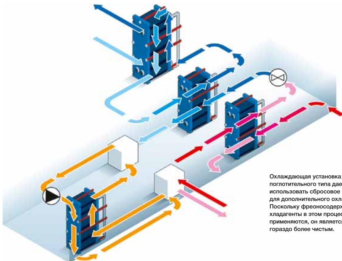
Охлаждающая установка поглотительного типа дает возможность использовать сбросовое тепло для дополнительного охлаждения. Поскольку фреоносодержащие хладагенты в этом процессе не применяются, он является экологически гораздо более чистым.
