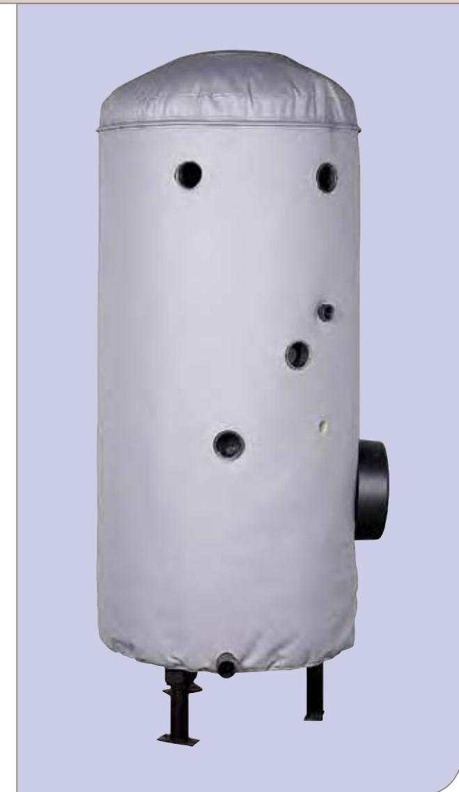
AquaTank особенно хорош в этом отношении, благодаря продуманному расположению внутренних трубопроводов. Поступающая холодная вода равномерно распределяется в нижней части бака, что не позволяет ей смешиваться с горячей водой. Горячая вода разбирается из самого верха цилиндрического бака. Поскольку вертикальные баки-накопители намного эффективнее горизонтальных, баки AquaTank выполнены в вертикальном исполнении.
