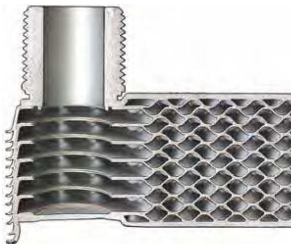
При пайке медью последняя используется в качестве заполнителя (припоя) для соединения между собой пластин из нержавеющей стали в паяльной печи. Тонкий слой меди плавится в точках контакта между гофрированными пластинами при высокой температуре. Поскольку медь обладает хорошим капиллярным эффектом, т. е. способностью смачивать пластину и заполнять щели, припой скапливается в местах контакта пластин, тем самым герметизируя и упрочняя образуемый ими пакет.
