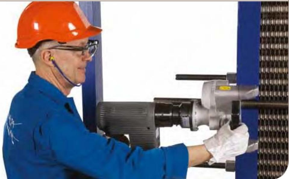
Электрический гайковерт РНЕ-ЕТД80 служит для механизации процесса вскрытия и закрытия пластинчатых теплообменников. Высокий класс защиты IP 54, возможность использования разного напряжения и частоты тока для питания привода делает устройство надежным и универсальным инструментом, способным работать от большинства электросетей и генераторов.
