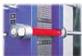
Ролик на прижимной пластине и опорные подшипники на стяжных болтах облегчают закрывание и открывание теплообменника.
