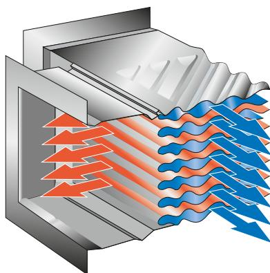
Горячий и холодный потоки движутся в перекрестных направлениях в каналах, образованных сваренными попарно гофрированными пластинами.
