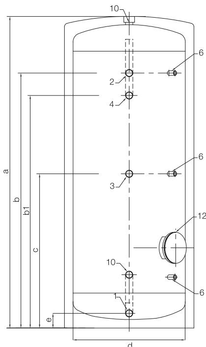
Особая конструкция теплоизоляции позволяет избежать возникновения эффекта естественной тяги в зазоре между баком и ю, что обеспечивает минимальные потери тепла. Технология этого типа соответствует самым жестким требованиям, включая нормы EnEv (Германия).
