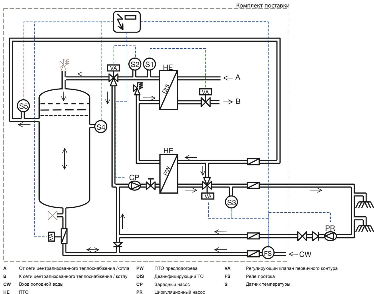
**Примечание:** На приведенной выше иллюстрации изображена система с баком-накопителем, в которой используется комбинированный реакционный бак. В крупной системе водоснабжения возможно использование 2 отдельных баков. Бак(и) не входят в комплект поставки AquaProtect и заказываются отдельно.
