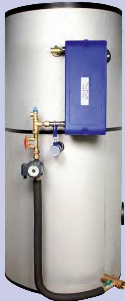
Если потребность в горячей воде оказывается меньше объема воды, нагретого за счет потребляемой в ПТО мощности, избыточный объем воды, нагретой теплообменником, сохраняется в накопительном баке. Когда расход горячей воды соответствует потребляемой в ПТО мощности, теплообменник компенсирует энергозатраты, не оказывая влияния на объем хранящейся горячей воды.
