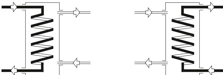
Теплообменник всегда должен работать по принципу противотока, и, если это допускают конструкционные материалы, поток с большим расходом должен быть на стороне кожуха.
