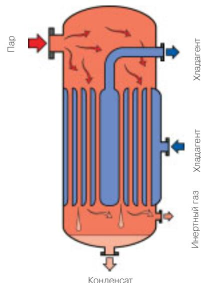
Сотрудничество с компанией Альфа Лаваль позволяет нашим заказчикам оптимизировать свои производственные процессы и внедрять новые технологии теплообмена. Примером эффективного технического партнерства может служить эта полностью собранная конденсационная колонна с тремя встроенными спиральными теплообменными блоками.
